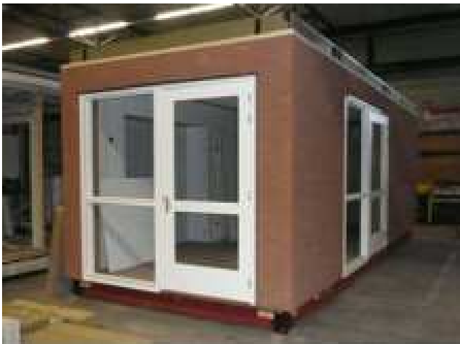
Foto's 2.1.1 Links: woonunit in fabriek Rechts: plaatsen van woonunit
